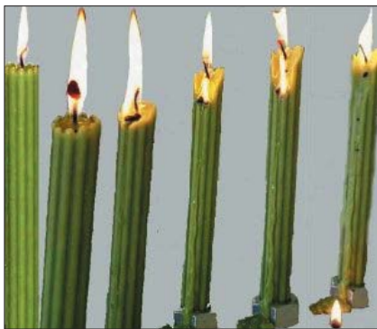
Abb. 18: Bildung eines zweiten Dochtes durch abfallenden Butzen
